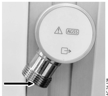
Figure 8-3 • Connexion du S.E.G.A
